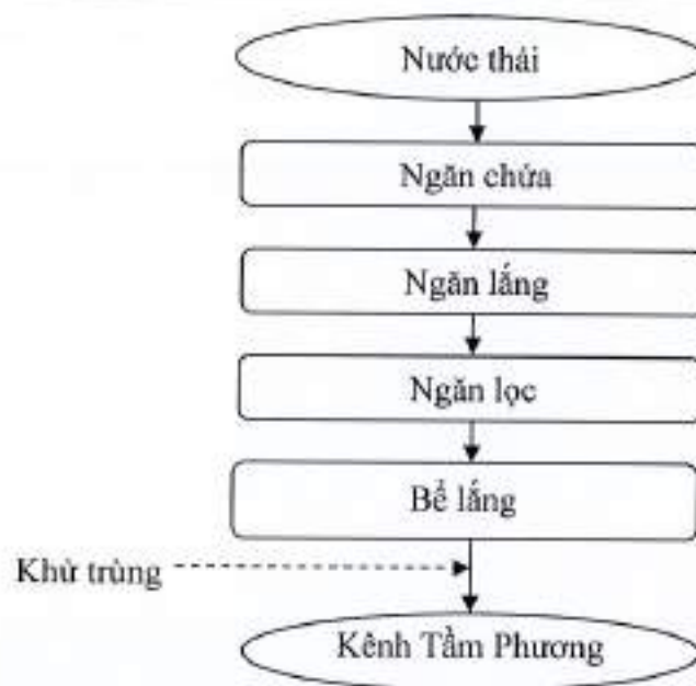
Hình 6: Quy trình xử lý nước thải sinh hoạt bằng hầm tự hoại
