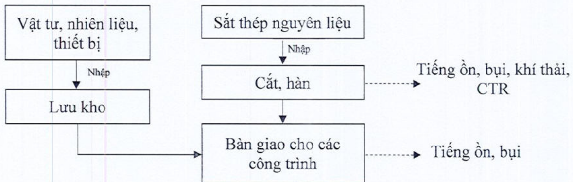
Hình 1.3. Quy trình gia công sắt thép tại cơ sở
